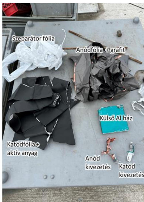
21. ábra: LFP akkumulátor részegységei (saját felvétel)
