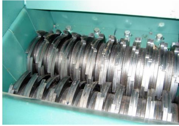
9. ábra: Forgótárcsás nyírómű felülnézete (Faitli és társai, 2017)
