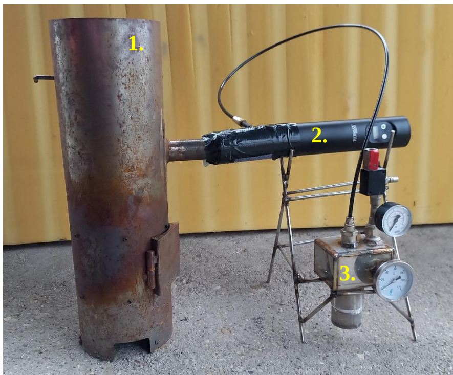
6. ábra: a füstgázkísérlet összeállítása: 1. tűztér; 2. kompresszor; 3. reaktor
