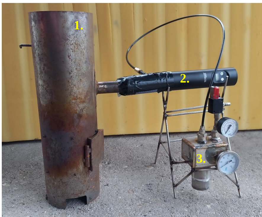
6. ábra: a füstgázkísérlet összeállítása: 1. tűztér; 2. kompresszor; 3. reaktor
