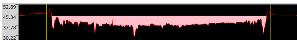
6.21. ábra Kopási keresztmetszet a koptatási iránnyal párhuzamosan felvett egyenes mentén a 731 SRV azonosítójú próbadarab esetében
