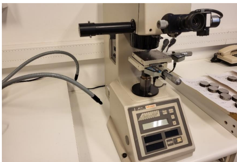
6.1. ábra A mikrokeménység mérésére használt Mitutoyo MVK-H1 keménységmérő műszer
