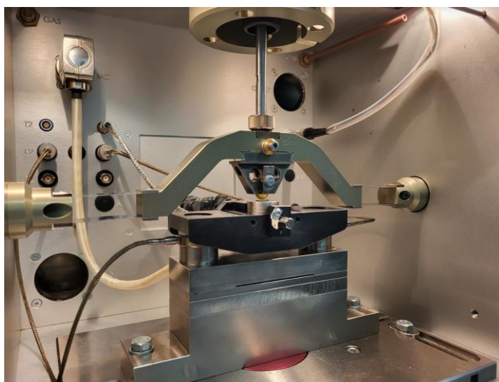
6.3. ábra Koptatóvizsgálat az Optimol SRV5 tribométerrel
