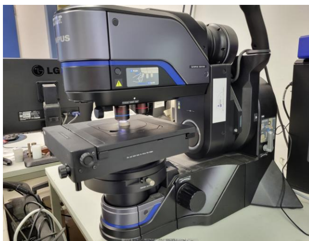
6.19. ábra Próbadarab az Olympus DSX1000 digitális mérőmikroszkópban
