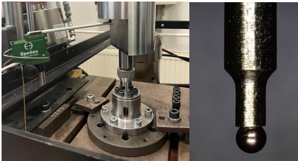
14. ábra. A mérési összeállítás a laboratóriumban, valamint a „punch” kialakítása
