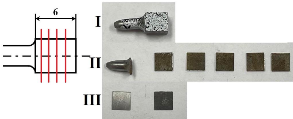
11. ábra. A szakító próbatest feldolgozásának szakaszai
