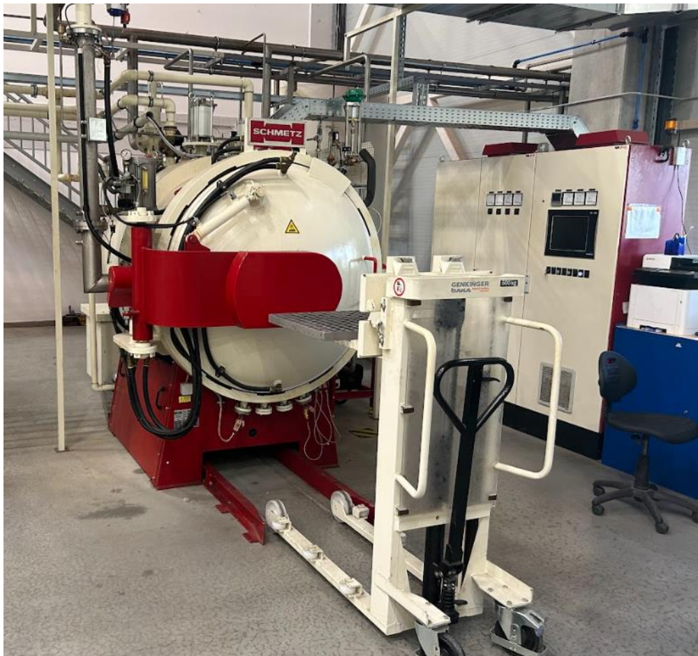
22.ábra. IU72/1F 2RV 60x60x40 10 bar CP Schmetz típusú vákuum kemence és szabályozó berendezése, ebben a kemencében történtek a hőkezelések)
