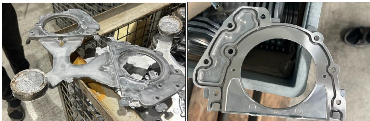
15.ábra A szerszám utómunkálatok előtt és után
