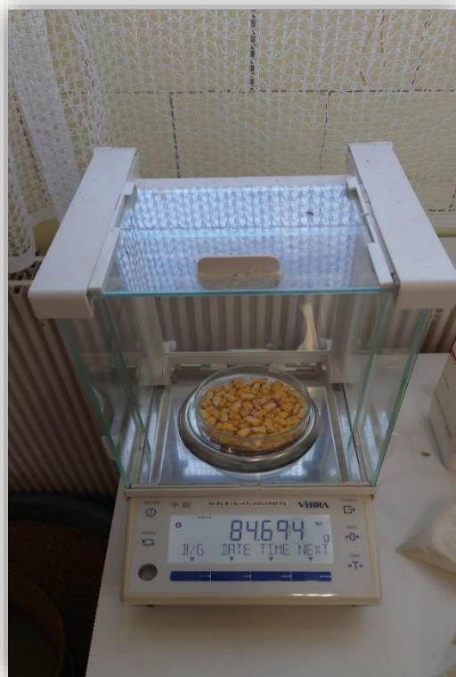
12. ábra: Analitikai mérleggel történő ezermagtömeg mérés
