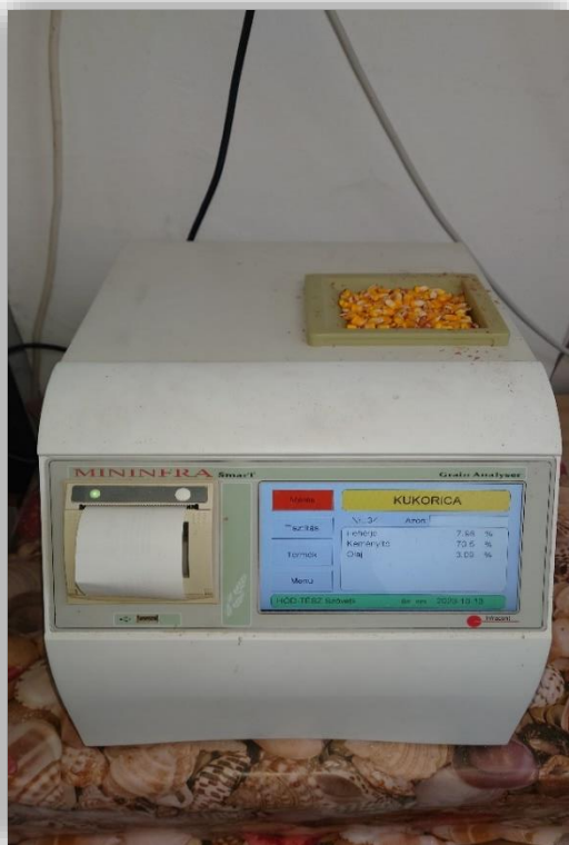
11. ábra: A beltartalom meghatározása Mininfra Smart beltartalom mérővel
