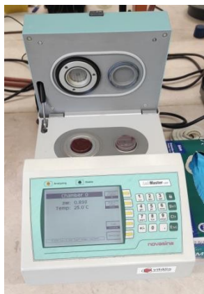
11. ábra NOVASINA LabMaster vízáktivitás-mérő berendezés. Forrás: Saját felvétel
