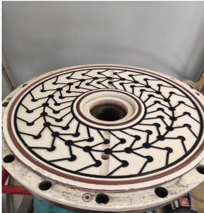
7. ábra A végtelenített, saját tervezésű 'Cikk-Cakk' kialakítású áramlásterelő membránszűrő modul alsó részébe illesztve
