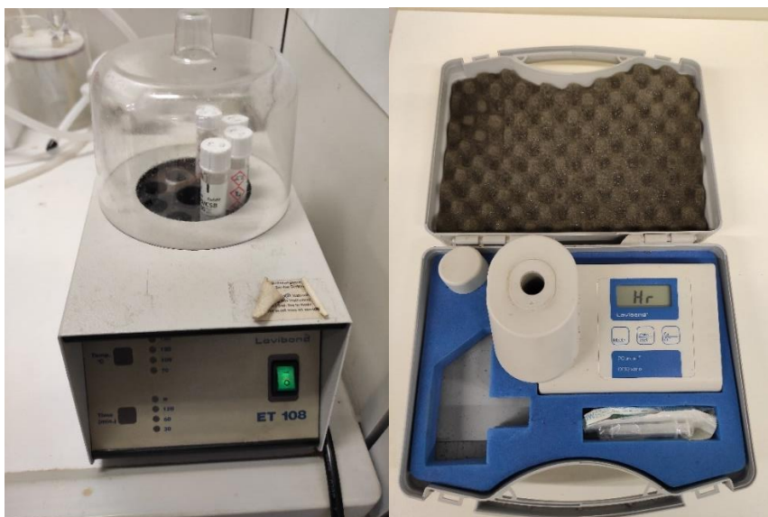
11. ábra Szerves anyag tartalom meghatározására alkalmas KOI mérő berendezés (jobb) (saját kép) és roncsoló blokk (bal) (saját kép)
