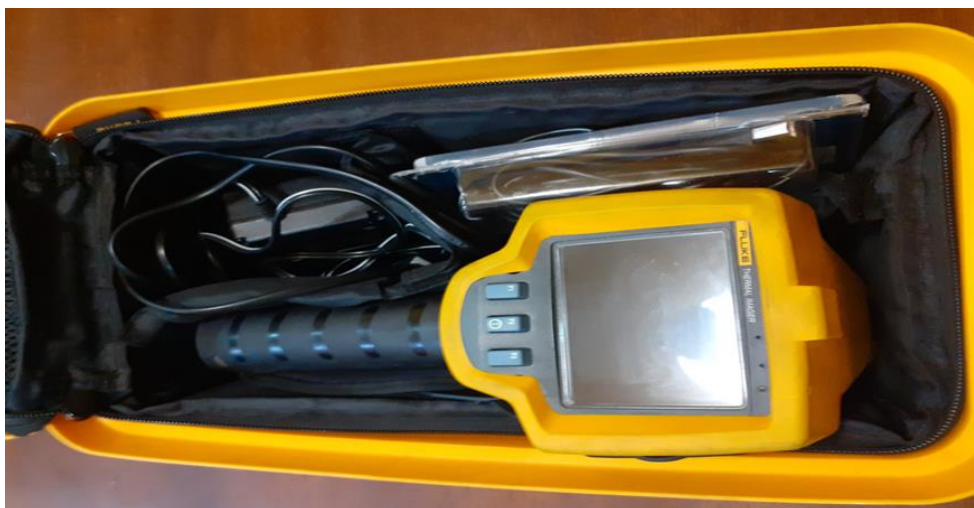
4. ábra: Fluke Ti25 ipari hőkamera (Forrás: saját készítésű fénykép)
