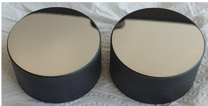
2.3 ábra: Nyomópogácsák polírozás után
