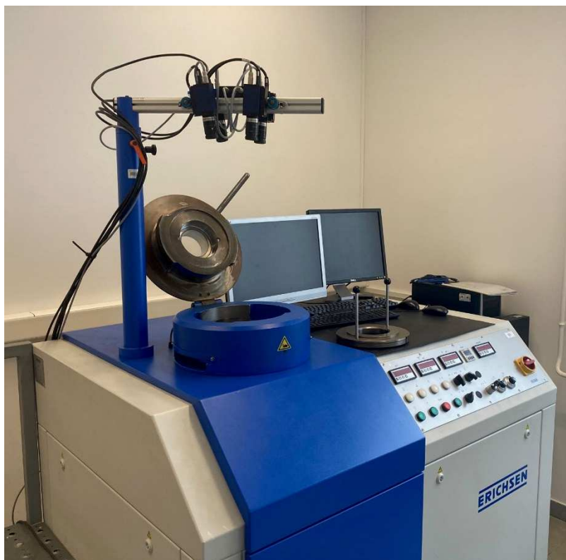
9.ábra Erichsen univerzális lemezvizsgáló berendezés
