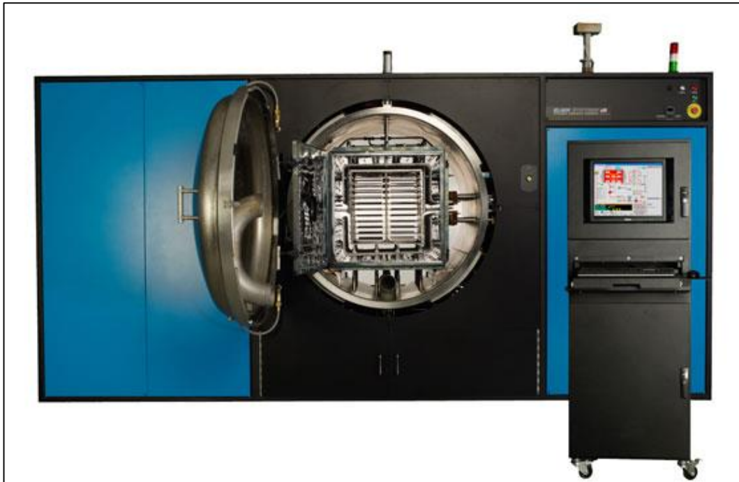
17. ábra. MIM 3045 típusú szinterelő kemence [29]
