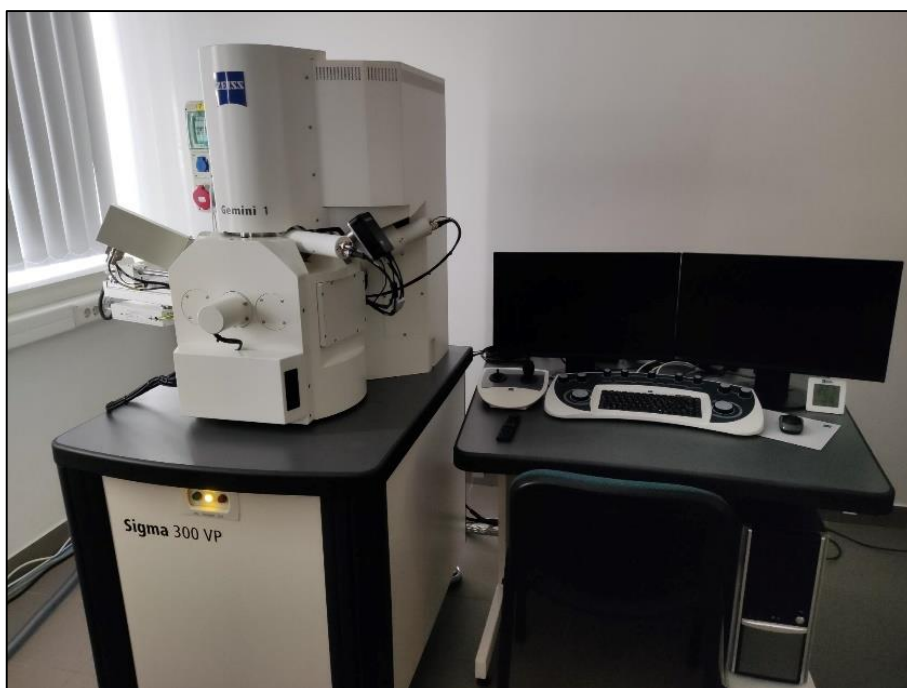
24. ábra. Zeiss Sigma 300 VP pásztázó elektronmikroszkóp
