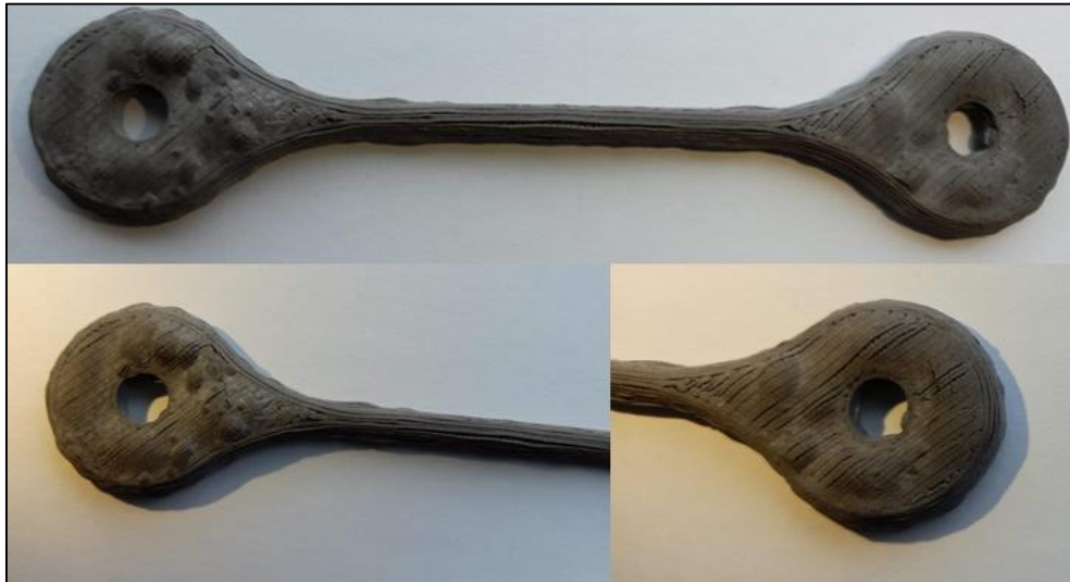
12. ábra Szinterelés utáni eredmény BASF filamentból az AFT Hungary Kft.-nél
