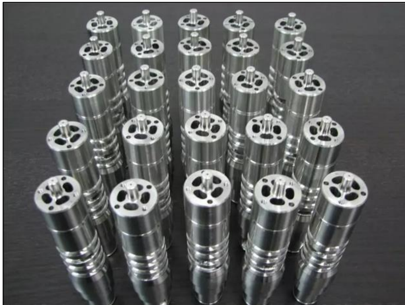
1. ábra. 30 darab korrózióálló extruder henger egyidejű gyártása [6]
