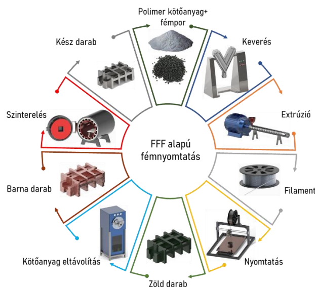
10. ábra. FFF alapú fémnyomtatás folyamata
