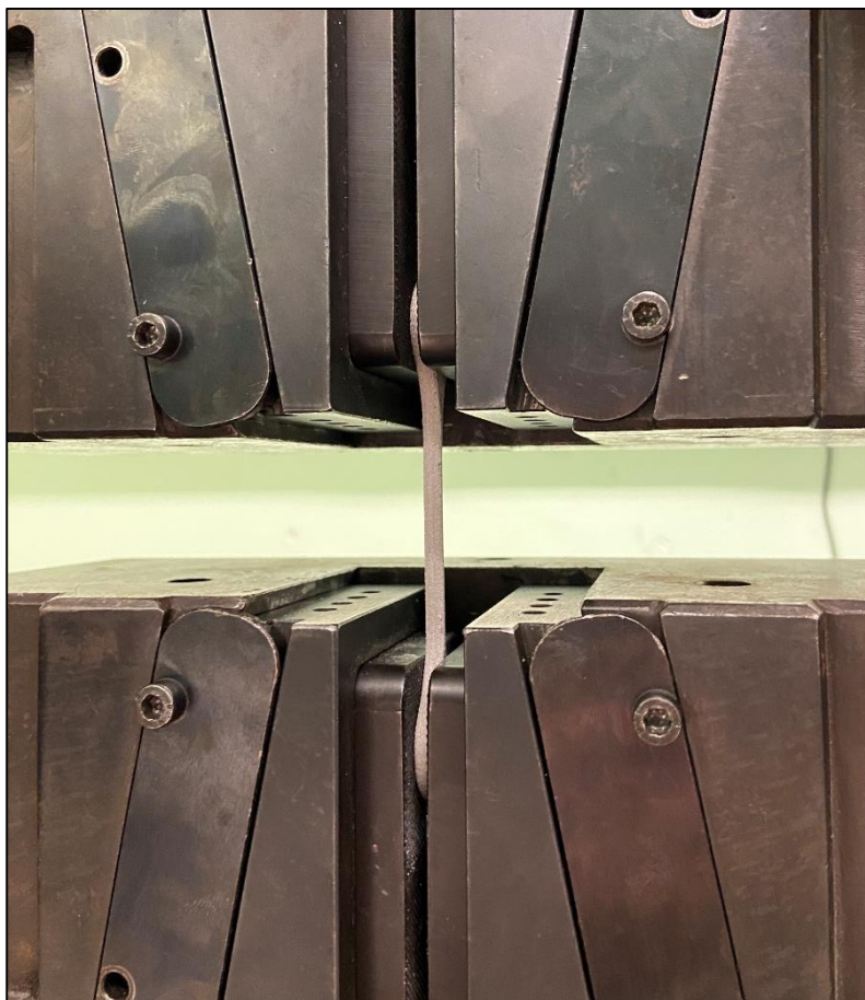
19. ábra. Próbatest a szakítógép befogó pofájában
