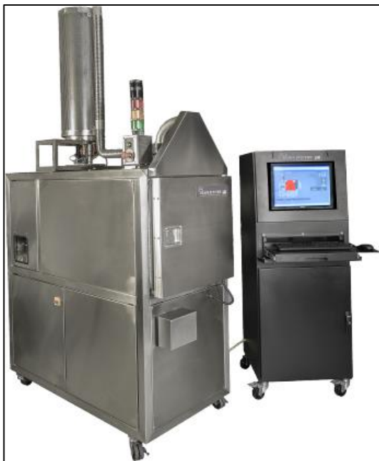
15. ábra. CD 3045 típusú kötőanyag eltávolító kemence [29]
