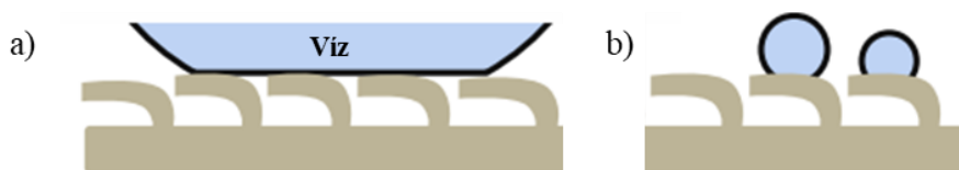
19. ábra: A mikro- és makronedvesítés sematikus ábrája: a) makronedvesítés; b) mikronedvesítés [35]
