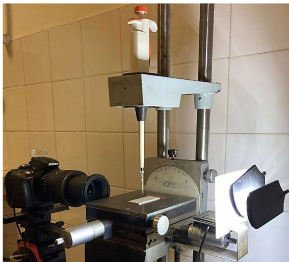
11. ábra: Alkalmazott nyugvócsepp módszeres peremszög mérési rendszer szemléltetése
