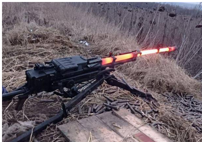
13. ábra: Túlhevült géppuska cső [22]
