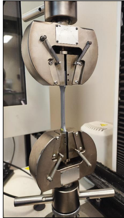
24. Ábra: munkadarab befogó készülékek, befogott mintával
