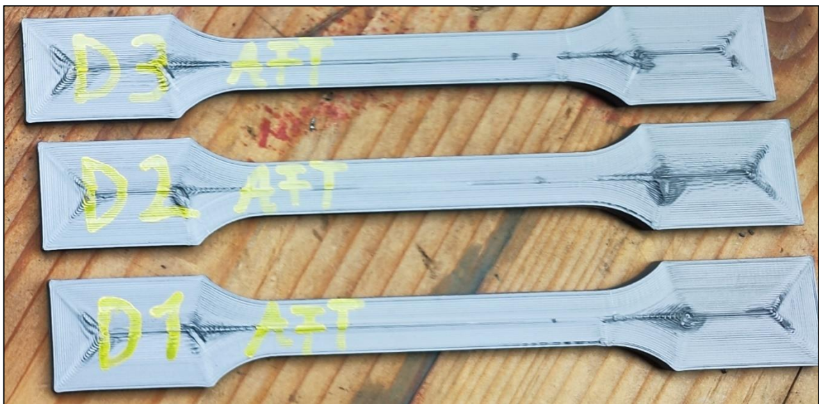
19. Ábra: A mérés szempontjából elhanyagolható hibákkal rendelkező mintadarabok.
