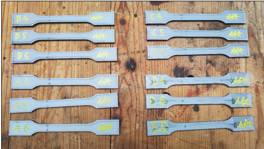
22. Ábra: Fárasztáson átesett munkadarabok. A felületeken látható feketés foltok a befogó által okozott koszolódás.
