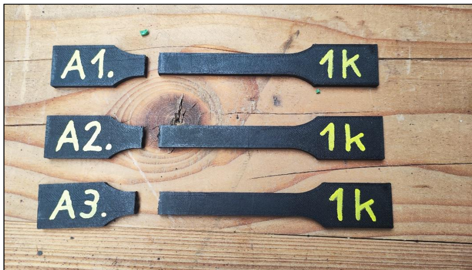
21. Ábra: Fárasztás közben eltört előtesztelő minták
