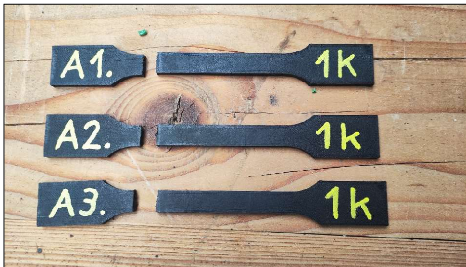
21. Ábra: Fárasztás közben eltört előtesztelő minták
