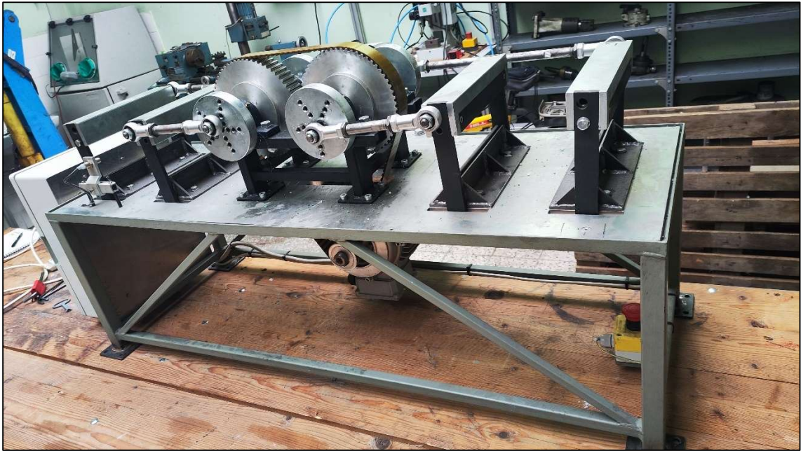
4. Ábra: A Neumann János Egyetemén található polimer fárasztó berendezés
