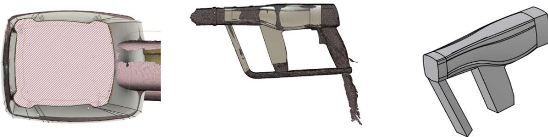
28. ábra: A pontfelhőből történő testmodell létrehozásának lépései
