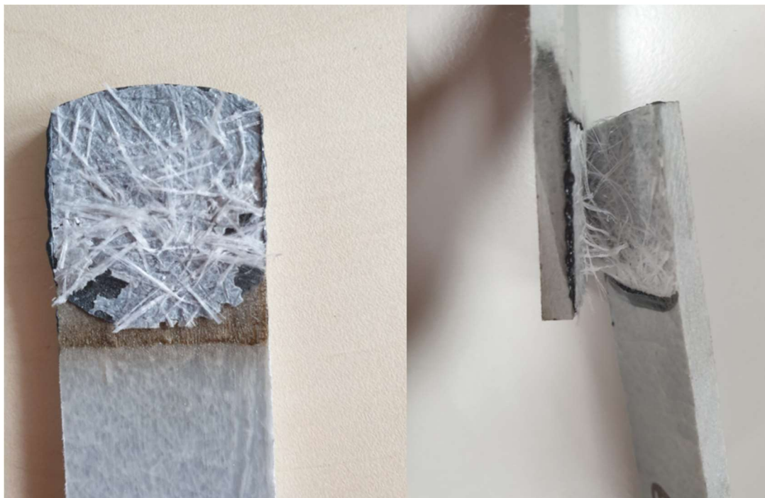
48. ábra: A szakítás utáni állapota a próbadaraboknak
