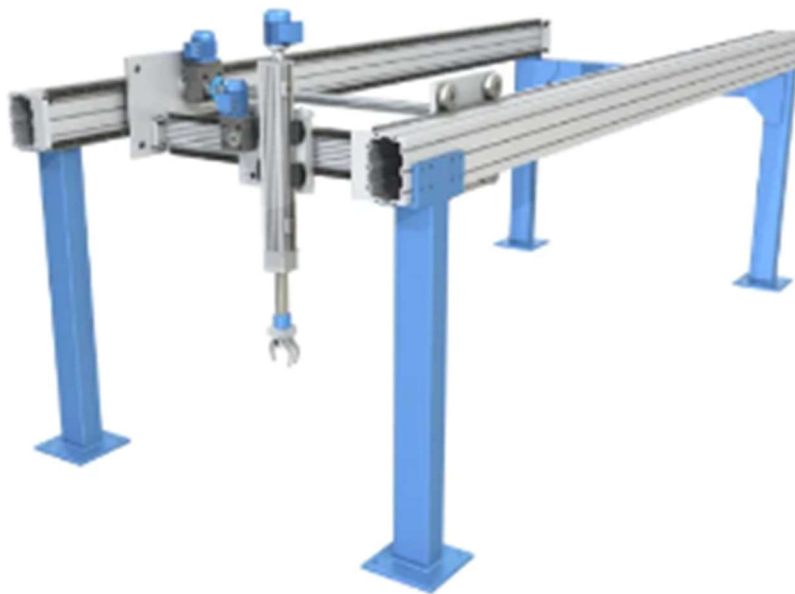
49. ábra: Az ajánlott kialakítása a portál rendszernek [33]
