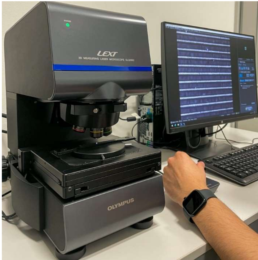
13. ábra: A vizsgálatokhoz használt konfokális mikroszkóp [14]
