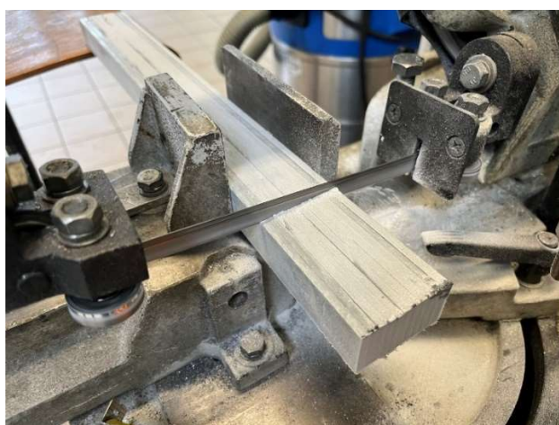
34. ábra: A GFRP szálak méretre vágása a fűrészgépen
