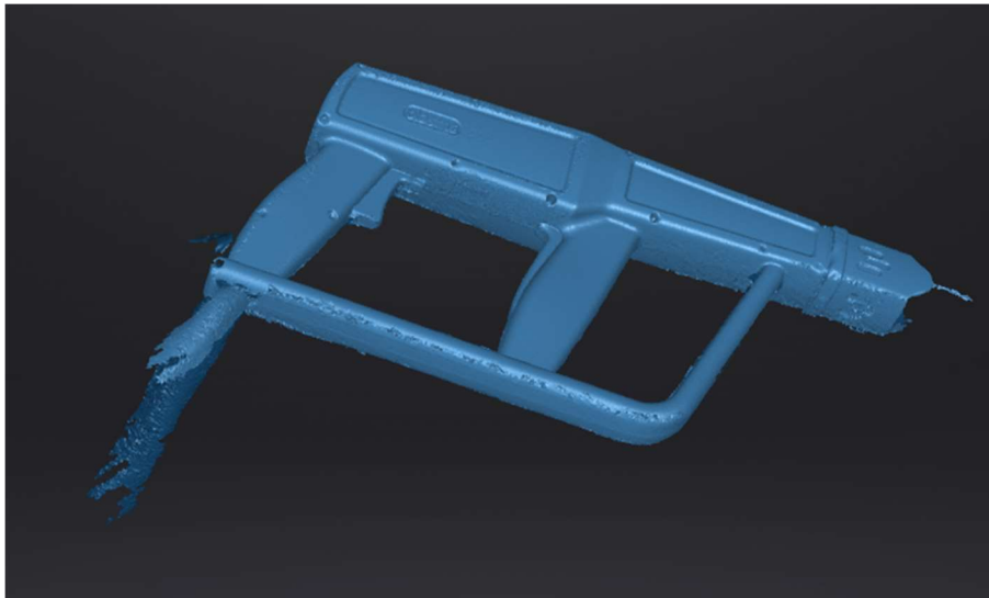
26. ábra: Lyukak és rések befedése utáni összefűzött plazmapisztoly
