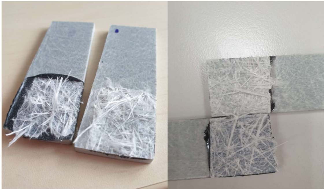
47. ábra: A tönkremenetel utáni állapota a próbadaraboknak
