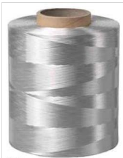
3. ábra: Rovingolt üvegszál [1]
