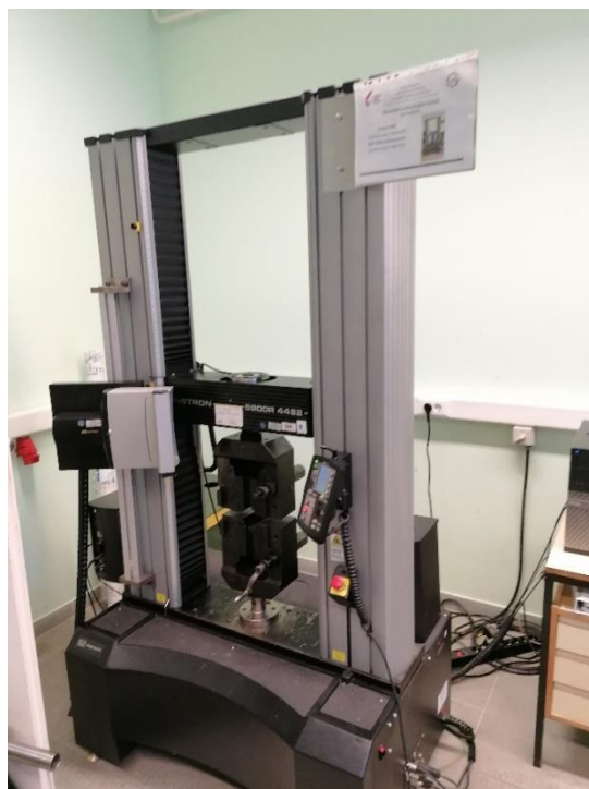
33. ábra: Szakítógép és a rajta található munkadarab befogók
