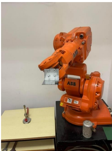
9. ábra Lángolási vizsgálathoz használt ABB robot
