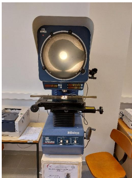
33. ábra Mitutoyo PJ-A3000 profilprojektor [Nagy Zsombor Lajos, szerző]
