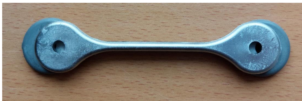
37. ábra Zöld és szinter termék zsugor szemléltetése [Nagy Zsombor Lajos, szerző]
