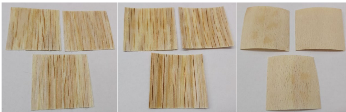
13. melléklet; Kísérlet a H_2O_2 és a NaOH 1/5 elegyével történő delignifikálásra. 60 perc (1 óra) UV-zás után kontrol; bal: kezeletlen tölgy, középső: hőkezet tölgy; jobb: bükk
