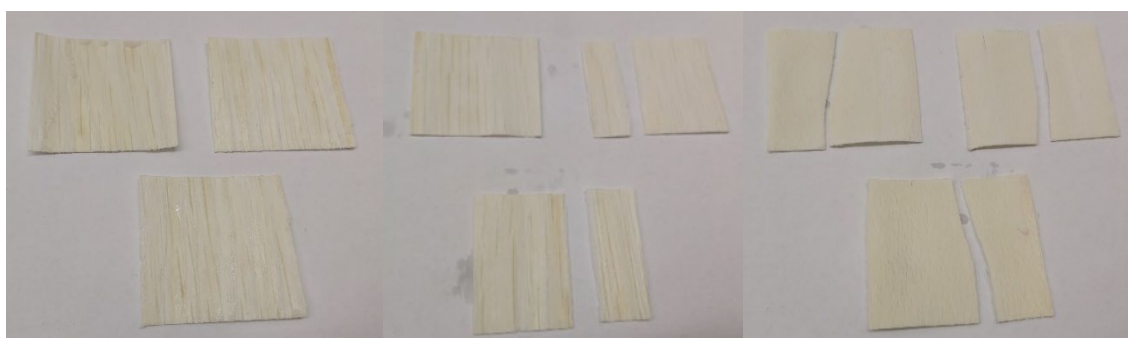
8. melléklet; Kísérlet a teljes delignifikálásra; 180 perc (3 óra) UV-zás után, bal: kezeletlen tölgy, középső: hőkezet tölgy; jobb: bükk
