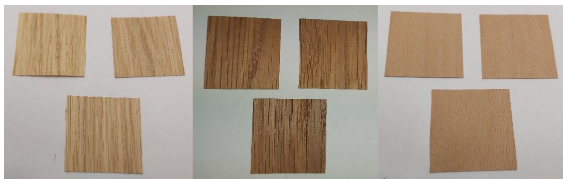
12. melléklet ; Kísérlet a H_2O_2 és a NaOH 1/5 elegyével történő delignifikálásra. kiinduló állapot; bal: kezeletlen tölgy, középső: hőkezet tölgy; jobb: bükk
