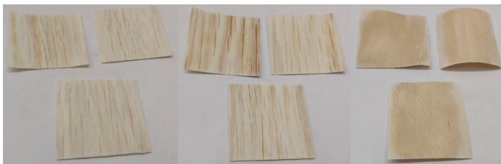
15. melléklet; Kísérlet a H_2O_2 és a NaOH 1/5 elegyével történő delignifikálásra. 120 perc (2 óra) UV-zás után kontrol; bal: kezeletlen tölgy, középső: hőkezet tölgy; jobb: bükk
