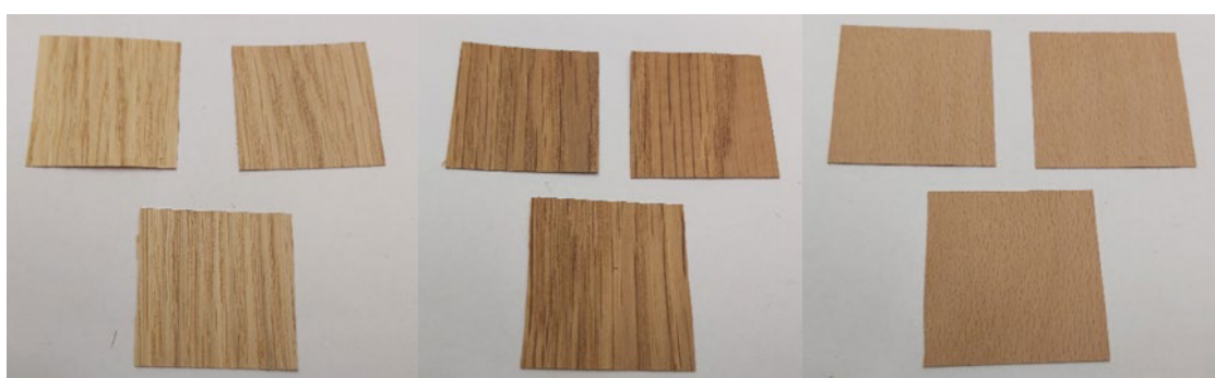
5. melléklet; Kísérlet a teljes delignifikálásra; kiinduló állapot, bal: kezeletlen tölgy, középső: hőkezel tölgy; jobb: bükk
