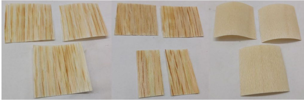
16. melléklet; Kísérlet a H_2O_2 és a NaOH 1/5 elegyével történő delignifikálásra. 120 perc (2óra) UV-zás után; bal: kezeletlen tölgy, középső: hőkezet tölgy; jobb: bükk
