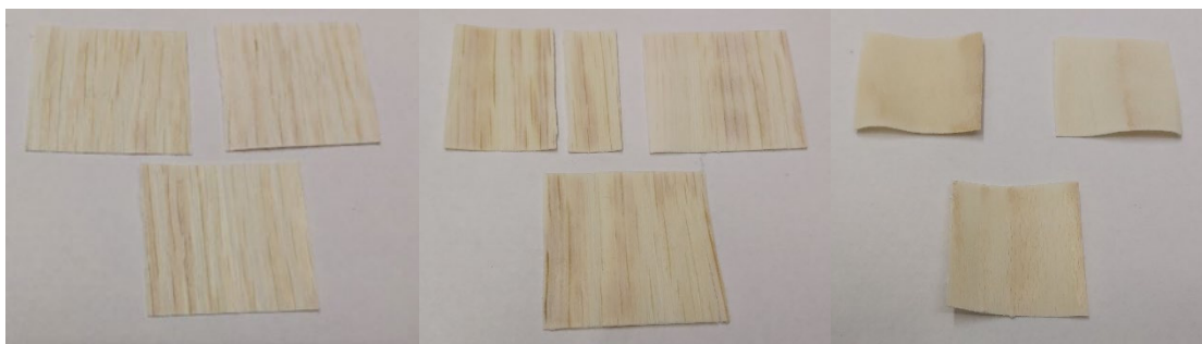
7. melléklet; Kísérlet a teljes delignifikálásra; 120 perc (2 óra) UV-zás után, bal: kezeletlen tölgy, középső: hőkezet tölgy; jobb: bükk
