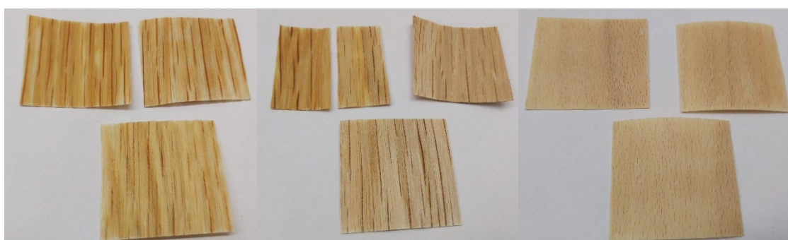
14. melléklet; Kísérlet a H_2O_2 és a NaOH 1/5 elegyével történő delignifikálásra. 60 perc (1 óra) UV-zás után; bal: kezeletlen tölgy, középső: hőkezet tölgy; jobb: bükk
