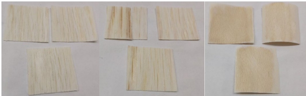
17. melléklet; Kísérlet a H_2O_2 és a NaOH 1/5 elegyével történő delignifikálásra. 180 perc (3óra) UV-zás után kontrol; bal: kezeletlen tölgy, középső: hőkezet tölgy; jobb: bükk
