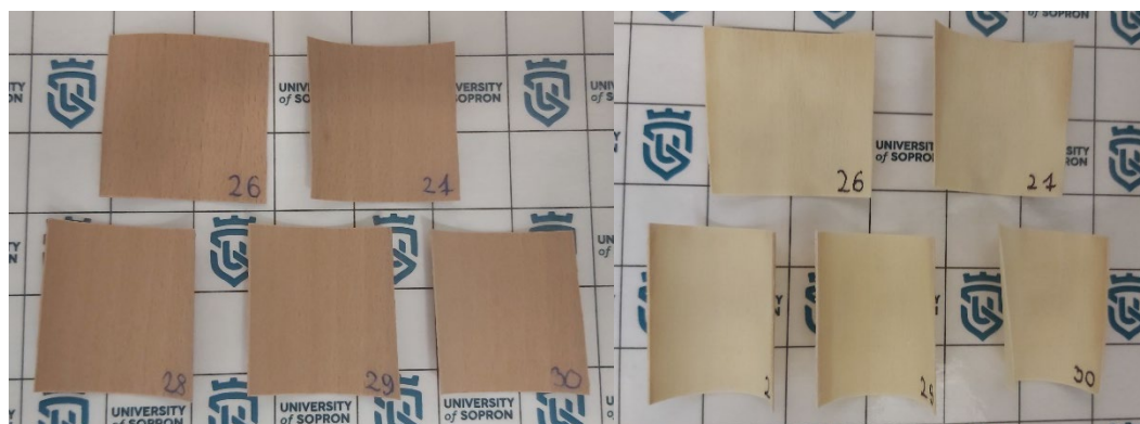
8. ábra Bükk minták 3.4.7. UV segített delignifikációs folyamat előtt és után. A bal oldali minták a kiinduló állapotot, a jobb oldali minták a delignifikált állapotot mutatják.
