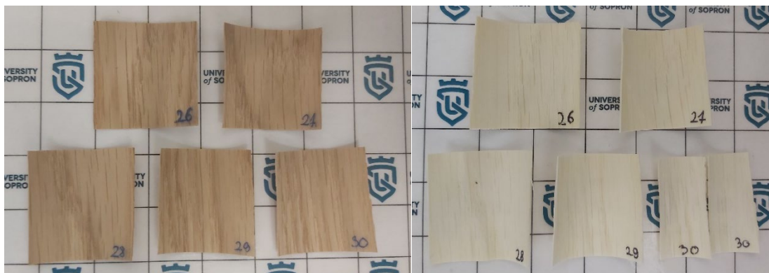
9. ábra Tölgy minták 3.4.7. UV segített delignifikációs folyamat előtt és után. A bal oldali minták a kiinduló állapotot, a jobb oldali minták a delignifikált állapotot mutatják.
