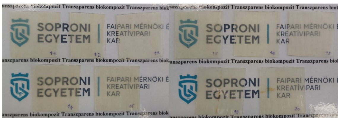
11. ábra Epoxigyantával telített faanyag minták bal oldalon tölgy, jobb oldalon bükk.
