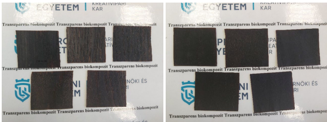
10. ábra PLA-val telített faanyag minták bal oldalon tölgy, jobb oldalon bükk.
