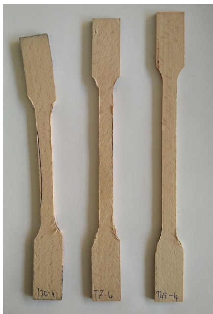
9. ábra Egyedi húzóvizsgálati mintatestek kialakítása
