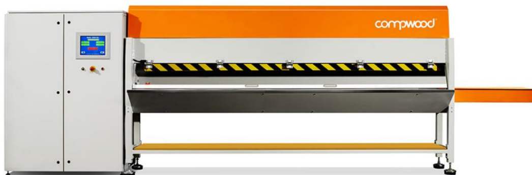
3. ábra Napjainkban használt modern tömörítőgép (forrás: http://compwood.com/ )
