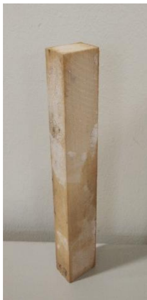
6. ábra Tömöríteni kívánt 20×30×200 mm méretű fagyasztott bükk mintatest
