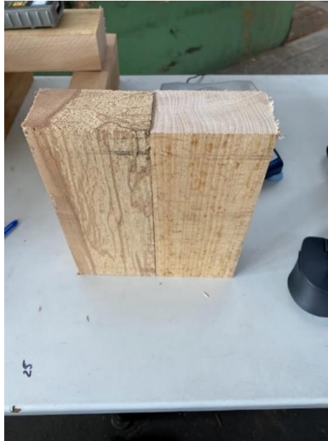
2. ábra Megfigyelhető a két bükk közötti eltérés, baloldali egy korhadáshoz közeli fülledés, míg a jobboldali egy kezdetleges fülledésű (saját kép).
