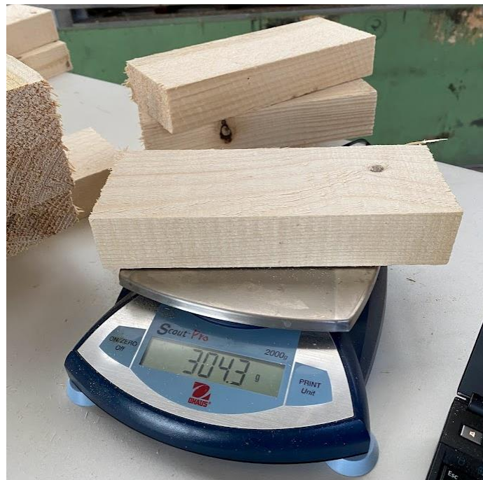
7. ábra A lucfenyő gyantatartalma megnehezíti a telítését (saját kép).
