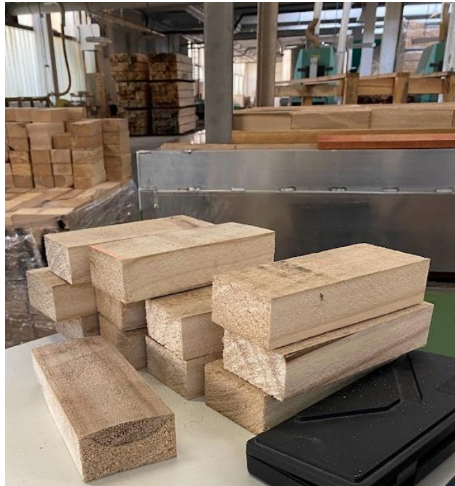
5. ábra Császárfán erősen kivehető a szíjács és geszt határa (saját kép).
