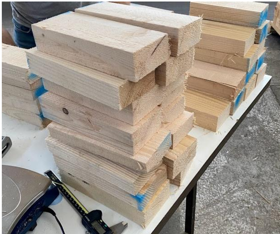
8. ábra A jegenyefenyőt telítés után kiválóan összelehet hasonlítani a lucfenyővel, megtudva mennyit számít a gyantatartalom (saját kép).
