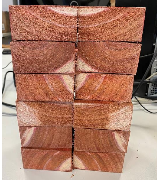
18. ábra Telítési hibák kirajzolódása hat félbevágott frízen, keresztmetszeten kiválóan látszanak a foltok (saját kép).
