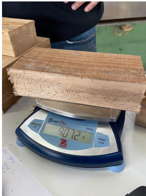
3. ábra Előfordultak kimagaslóan nagy tömegű próbatestek, melyet nem minden esetben követett magas nedvességtartalom (saját kép).
