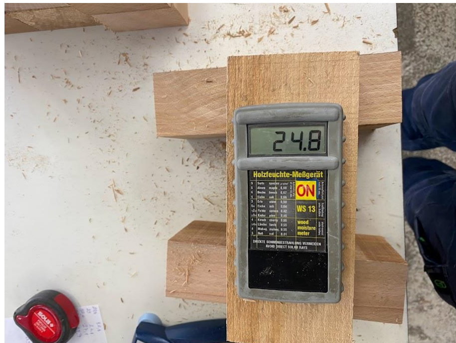
9. ábra Az érintőszondán megfelelő sűrűség beállítása után lehet csak mérni (saját kép).
