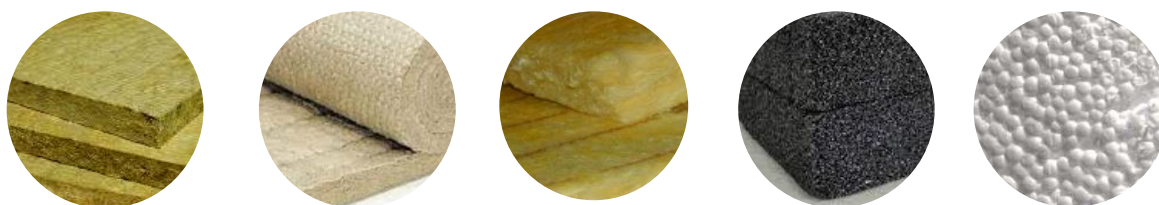
3. ábra Hagyományos hőszigetelő anyagok sorrendben balról jobbra: ásványgyapot, salakpamut, üveggyapot, üveghab, polisztirol
