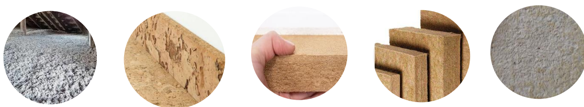
4.ábra Természetes alapú szigetelő anyagok sorrendben balról jobbra: fújt cellulóz szigetelés, parafa, agepán rost hőszigetelés, kender tábla, cellulóz kísérleti hőszigetelés
