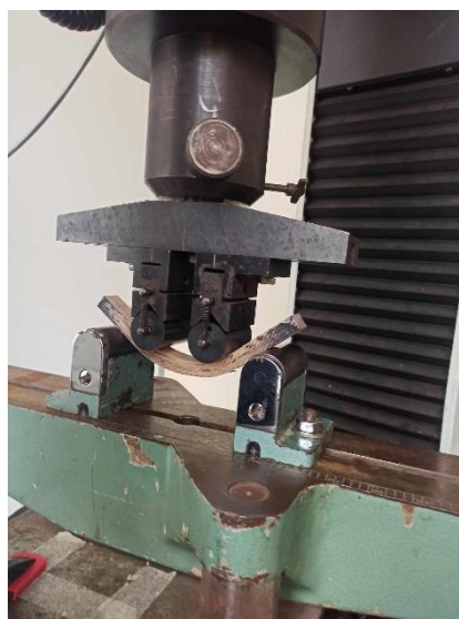
9. ábra Faanyag hajlítási vizsgálat közben
