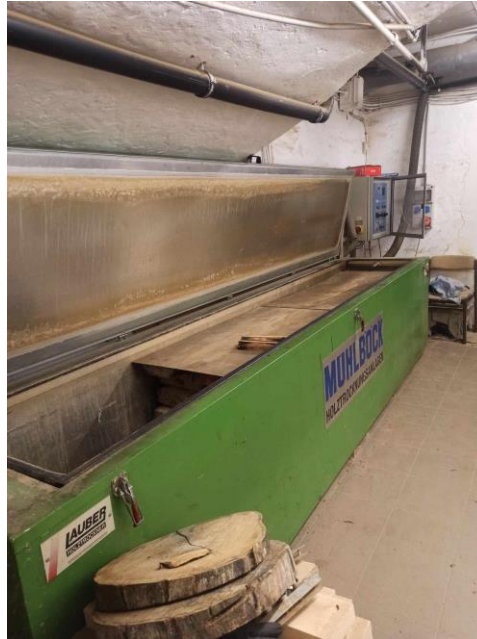
2. ábra A kutatás során használt konvekciós szárító
