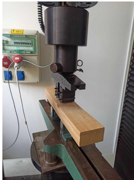
8. ábra Hajlító egységek párhuzamossági beállítása
