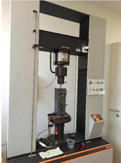
4. ábra INSTRON 4208 típusú golyósorsós univerzális anyagvizsgáló gép
