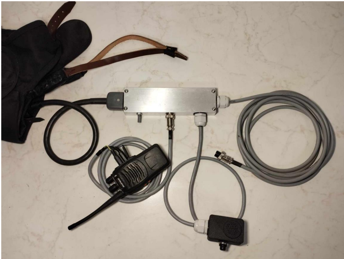
38. Ábra: rádiós csatlakozóegység (saját ábra)
