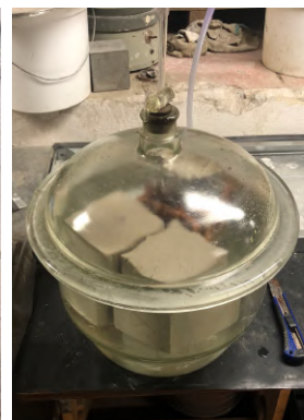
20. ábra: Mintakockák klímakamrában 21. ábra: Fokozatos telítés 22. ábra: Vákuum-exszikkátor 23. ábra: Trotec T510 mérés
