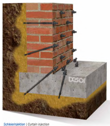
72. ábra: Fátyolinjektálás sémája (30)
