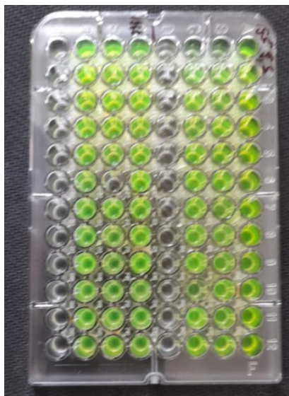
9. ábra: Az FDA módszer kivitelezése mikrolemezen
