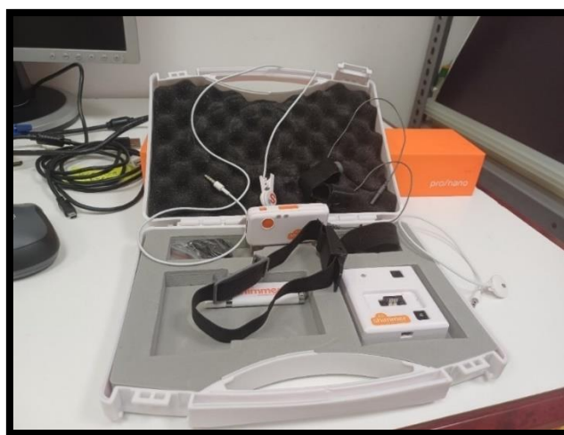
4. ábra: Shimmer 3+ bőrellenállás mérő készülék a csatlakoztatható érzékelőkkel (saját fénykép)
