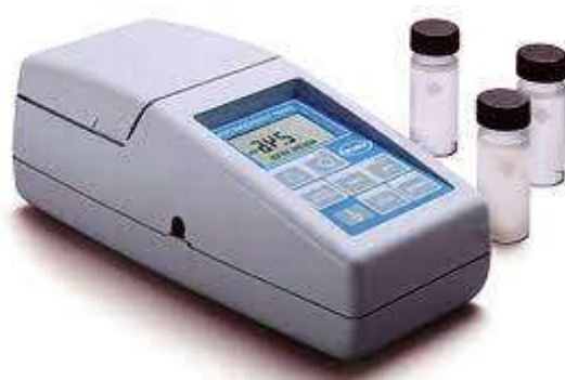
7. ábra: A mérésekhez felhasznált 2100P TURBIDIMETER (Internet 14)
