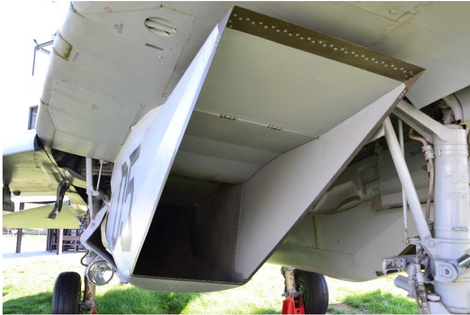
8. ábra: MiG-29 szívócsatorna szerkezeti megoldása az idegen tárgyak beszívásának elkerülésére [a szerző saját szerkesztése]
