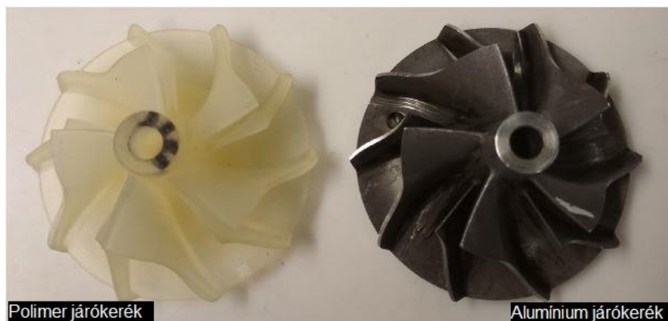
4. ábra - A vizsgált járókerekek fizikai modellje: polimer és alumínium [5]
