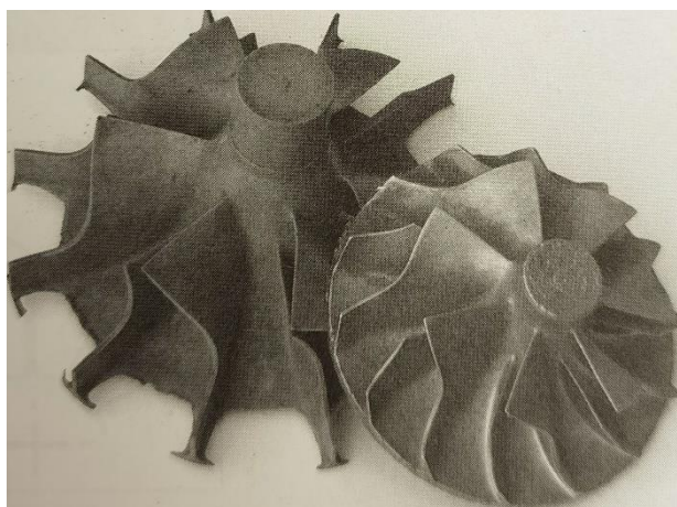
2. ábra - Sűrítő járókerék gumimintás technológiával gyártva [1]
