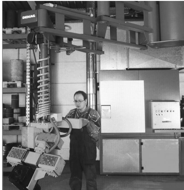
11. ábra: Nagyteherbírású manipulátor programozása (forrás: Kulcsár Béla, Robottechnika [2012])
