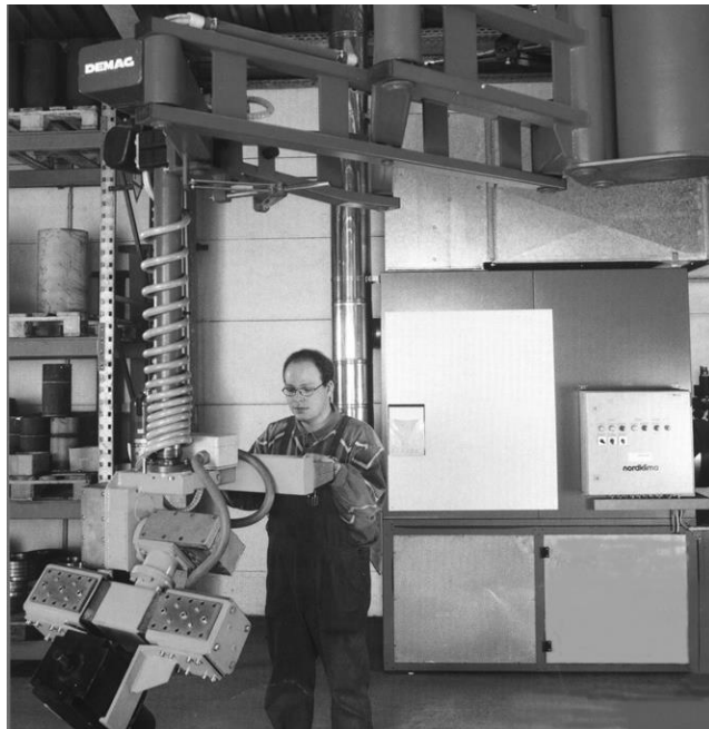
1. melléklet 11. ábra: Nagyteherbírású manipulátor programozása (forrás: Kulcsár Béla, Robottechnika [2012])
