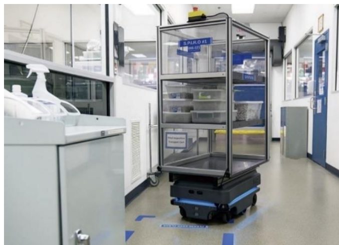
2. melléklet 4. ábra: Kórházi szállító robot
