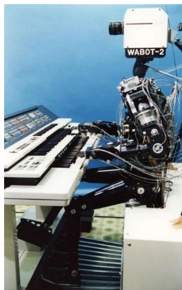
1. melléklet 9. ábra: A zongorázni képes robot (forrás: https://robotsguide.com/robots/wabot )
