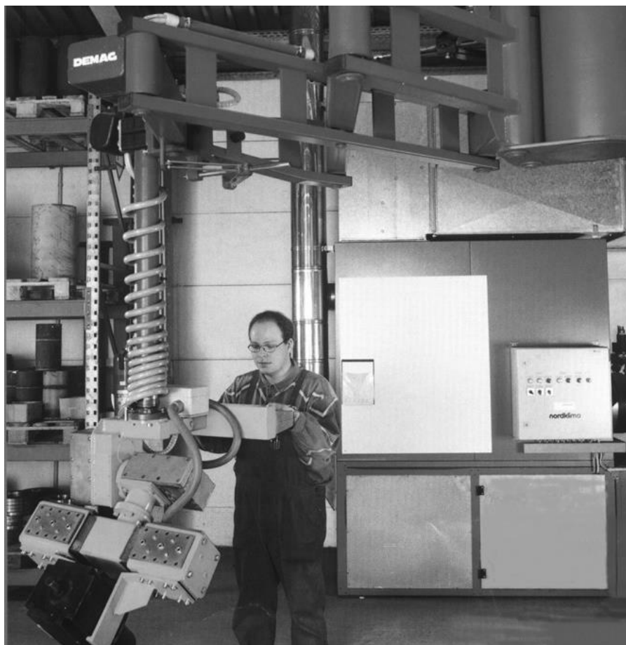
1. melléklet 11. ábra: Nagyteherbírású manipulátor programozása
