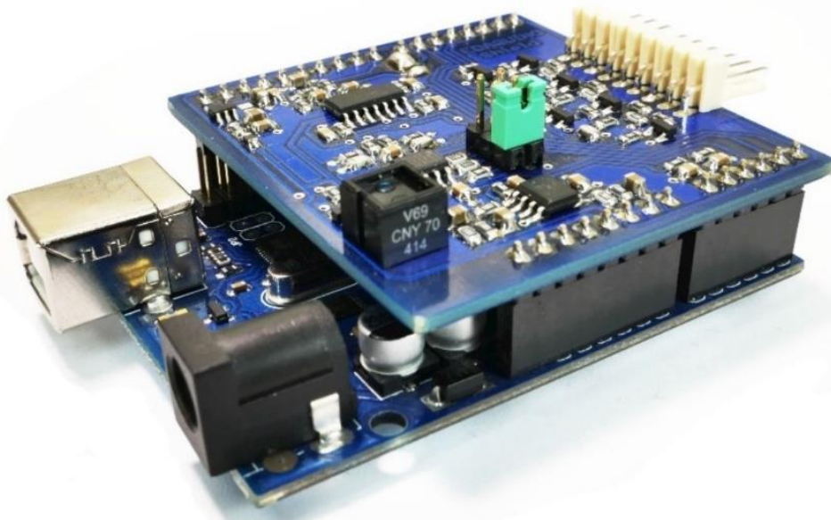
4. ábra: Az Arduino-hoz kényelmesen hozzáilleszthető feltét áramkör
