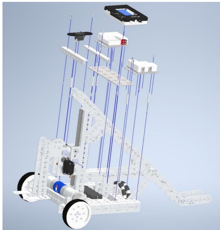
40. ábra: A vezérlők elhelyezése a roboton
