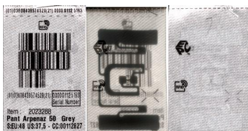
3. ábra: UHF RFID „tag” szövet ruhacímkébe integrálva előről, hátulról és átvilágítva
