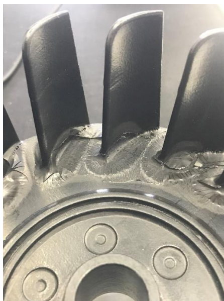
36. ábra Felületkezelés utáni felhólyagosodott felület
