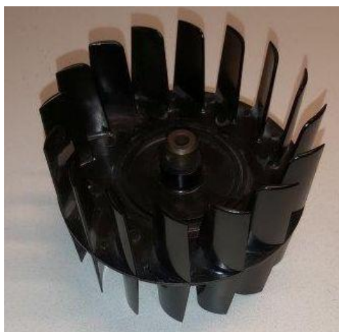
20. ábra Mercedes-Benz W113, valamint a beltéri levegő befűtésére szolgáló járókerék. [31] [32]
