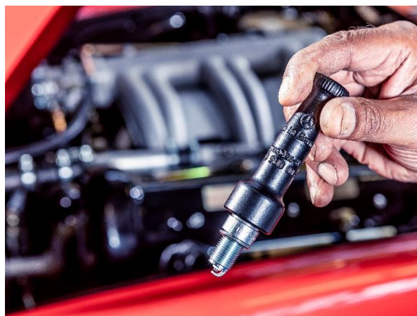
3. ábra Mercedes-Benz 300SL típushoz 3D nyomtatott alkatrészek. [6]
