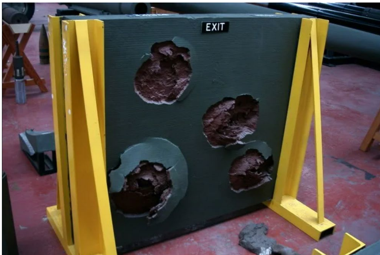
[9.Kép]: A HESH lövedék hatása a páncélzat belső oldalára
