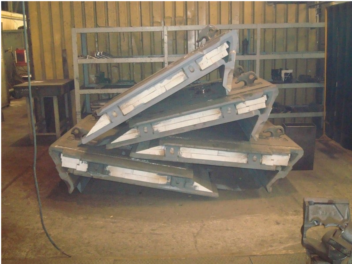
[5. Kép] A T-72-es frontpáncélzata, kívül és belül acél, közepén textolit réteggel.
