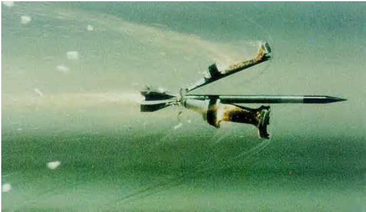
[7. Kép] Az űrméret alatti vezetősárnyas tolólapos leválóköpenyes páncéltörő lövedék köpenyének leválása
