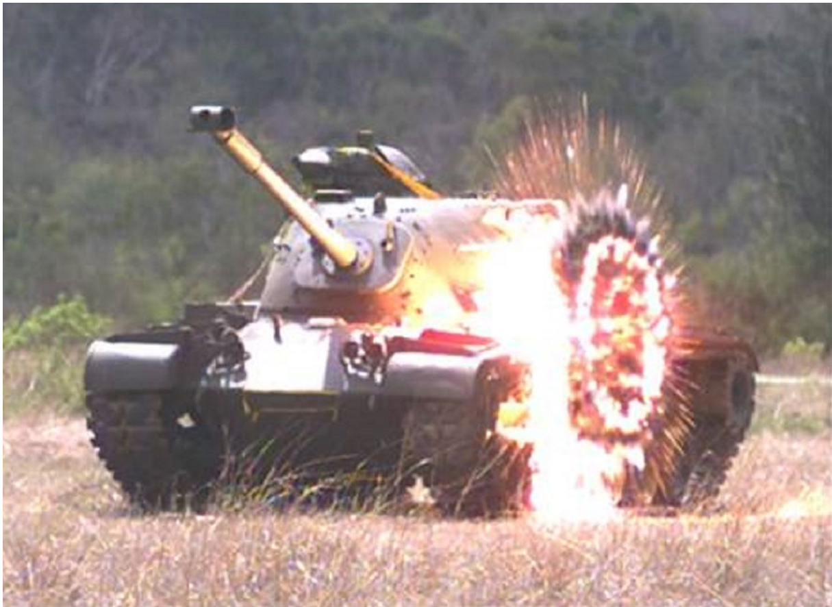
[8.Kép] Kumulatív lőszer a találat pillanatában
