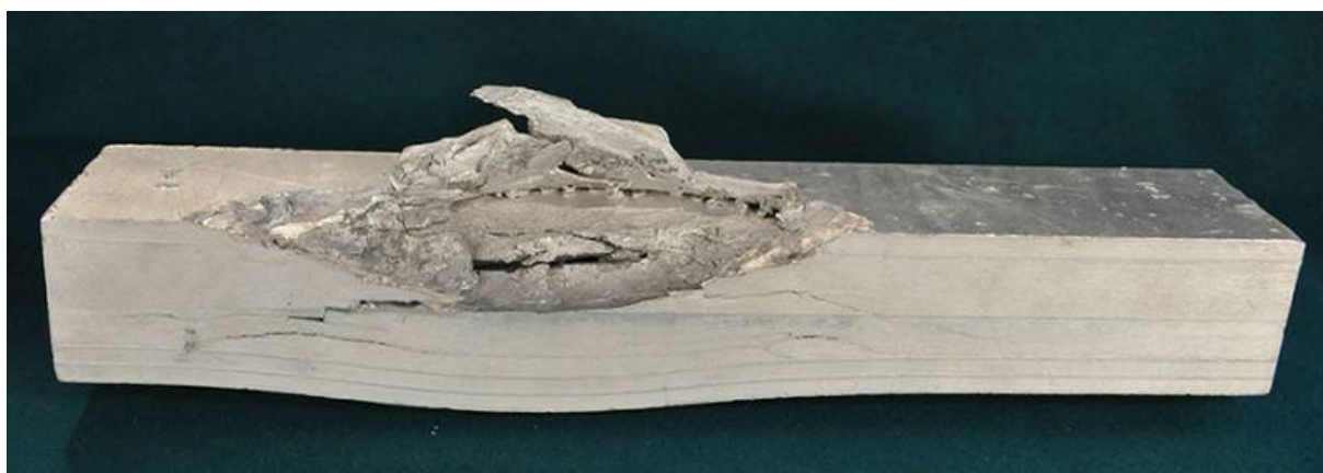
[4.Kép] A PASZ-1 becsapódási próbák után
