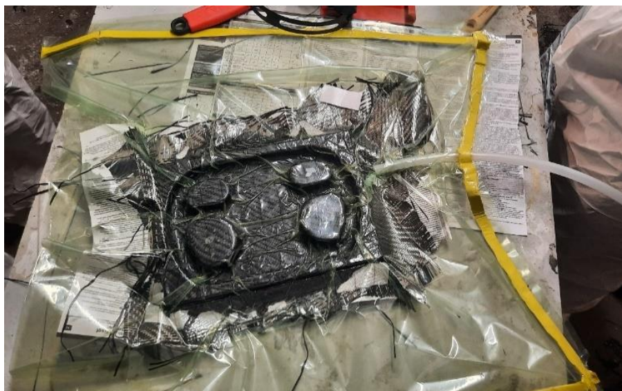
13. ábra: A kompozit alsó panel legyártása vákuumos technológiával
