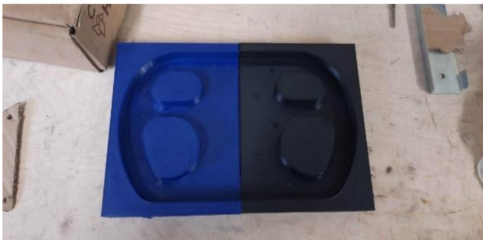
12. ábra: Az alsó panel 3D nyomtatott gyártási segédformája
