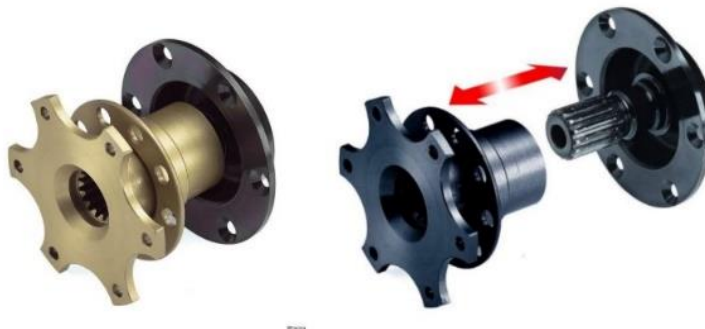
8. ábra: A bordás gyorscsatlakozó kinézete (bal) és működése (jobb) [9]
