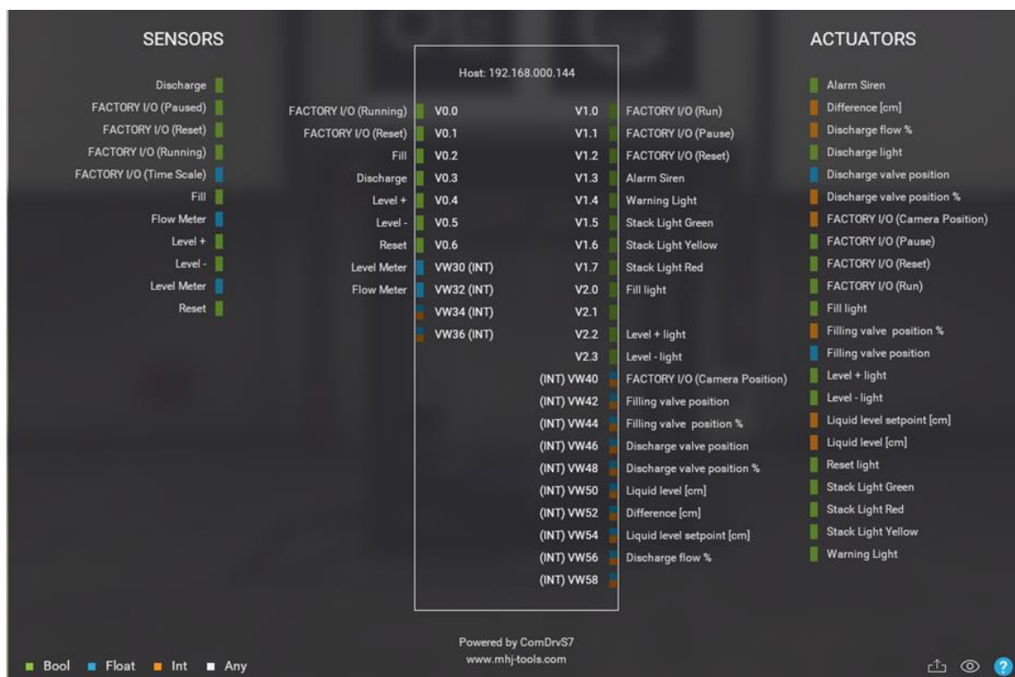
7. Kép: A tartály jelenet I/O listája [31]
