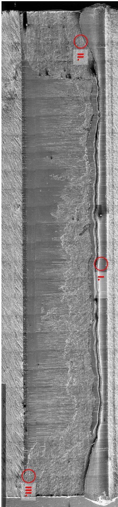
34. ábra Kompozit(K4) minta SEM mozaik felvétele és a jelölt részek részletei
