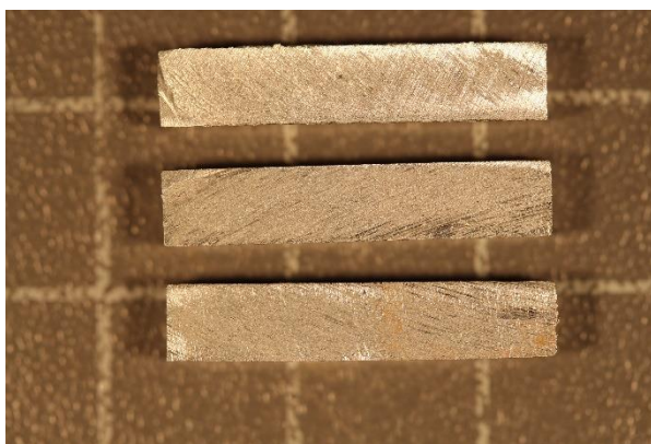
14. ábra Tömbi Al1050-es próbatestek
