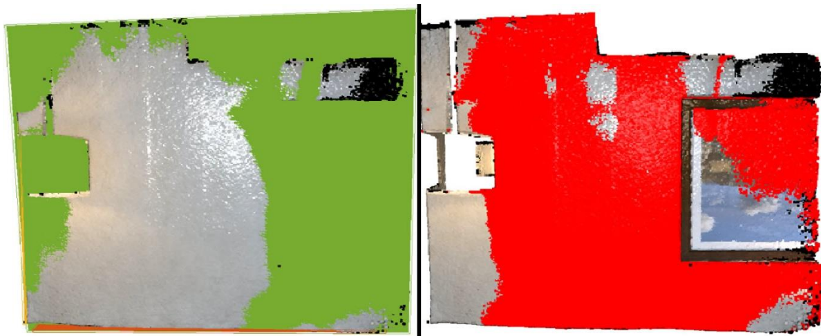
4. ábra - Planar patch detection (balra) és Plane segmentation (jobbra) sík létrehozási parancsok eredményei
