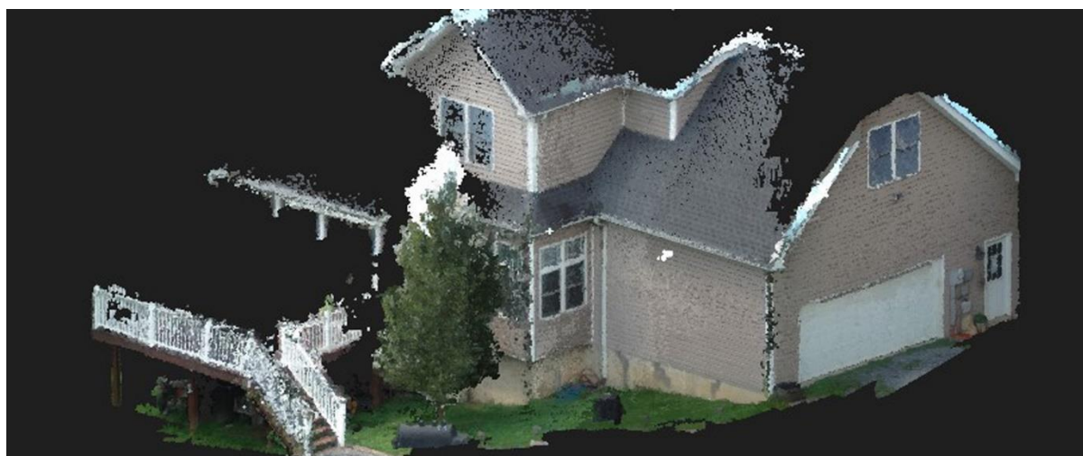
1. ábra - Egy épületről készült külső pontfelhő
