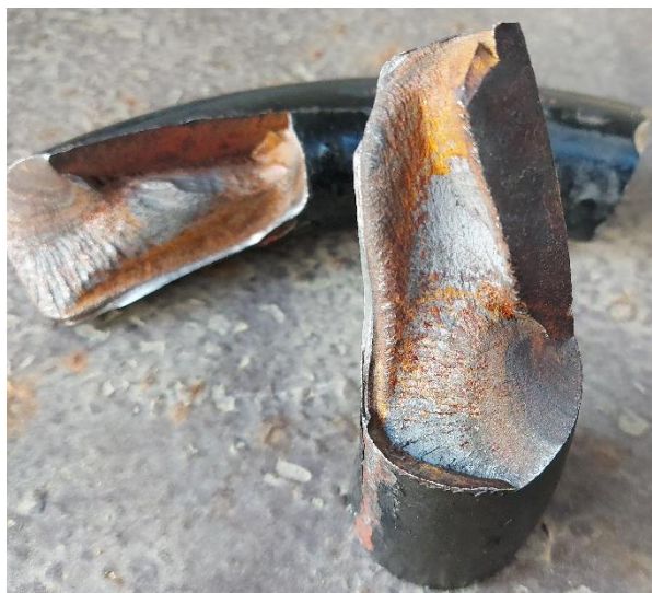
4.1. ábra A törés belső felületei
