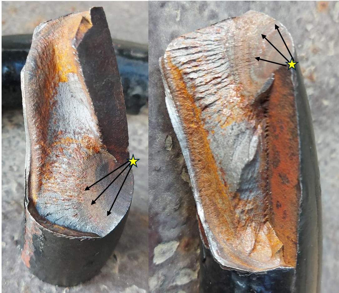
4.2. ábra A rugó töretfelülete
