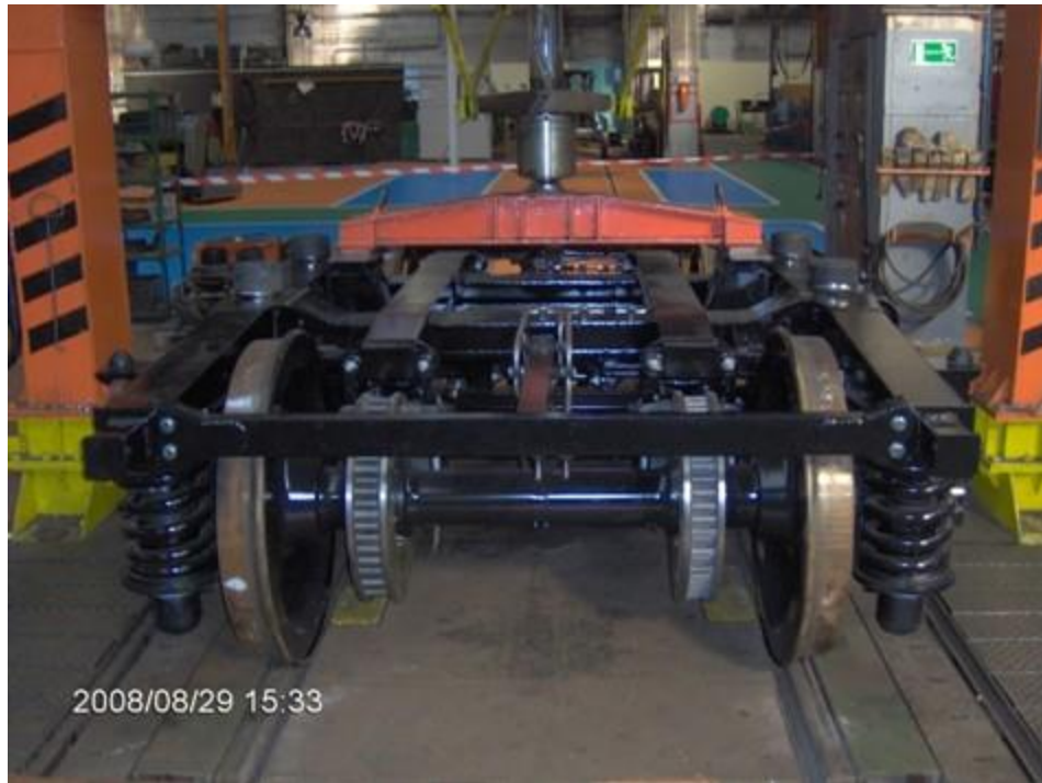
1.7. ábra Az átalakított forgóváz
