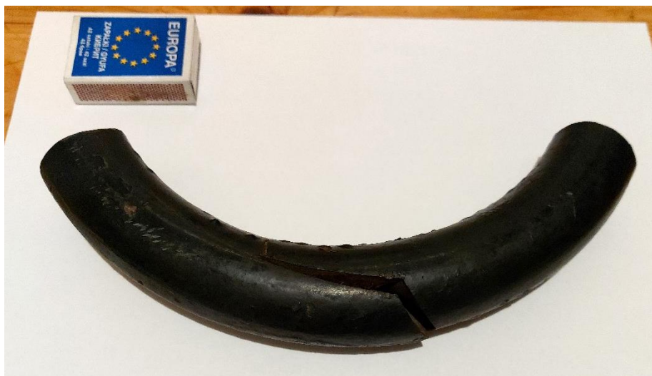
1.1. ábra A főcsavarrugó törött darabja
