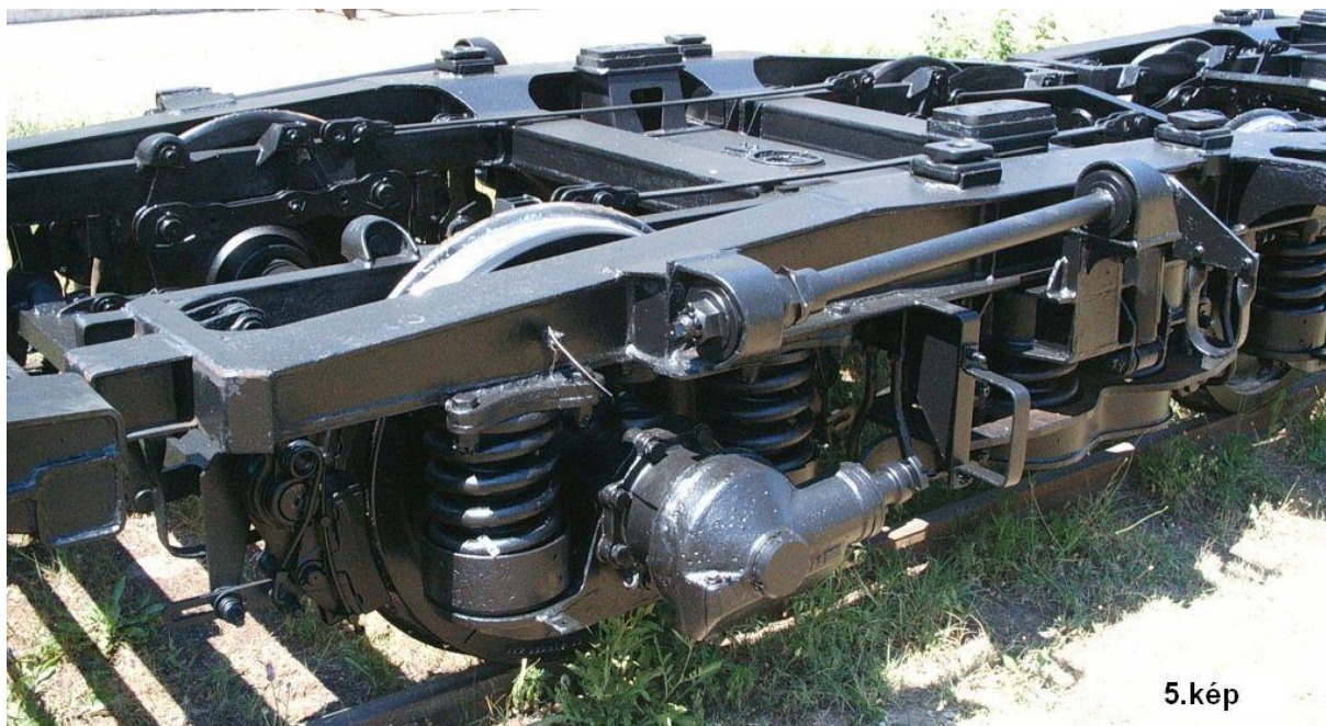
1.5. ábra Az eredeti Opole 4ANC forgóváz
