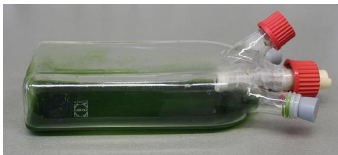
4. ábra: Vékony rétegű sejtszuszpenziót tartalmazó fotobioreaktor (PBR). A Roux-üveg 1 l-es térfogatú, melybe 100 ml algakultúra, a légtérbe egy erre kialakított csőben 20 g oxigén abszorbens került elhelyezésre (Nagy és mtsai., 2021).
