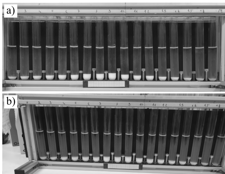
12. ábra. \text{BaCO}_3 csapadékoszlopok fényképe a kémcsőállványra merőlegesen (a) és ferdén fényképezve (b).
